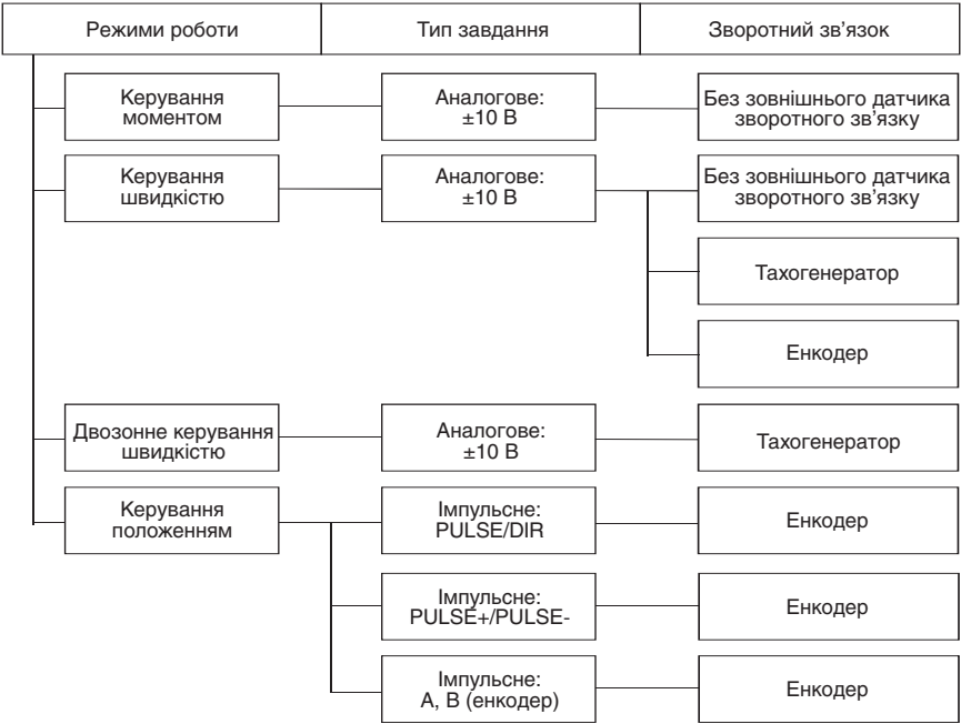
Мал. 1.3. Варіанти конфігурацій та режимів роботи сервоперетворювачів
